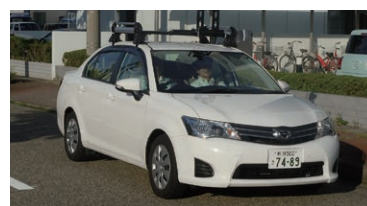
IRI 機器搭載車両による舗装点検
