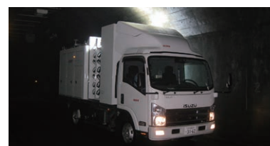
トンネル坑内走行画像計測
